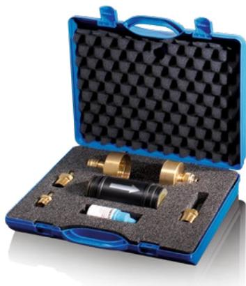
Filtro igienico Geberit: trattiene i microrganismi e le particelle di sporco, garantendo così che solo acqua igienicamente ineccepibile sia immessa nell'impianto durante la prova di pressione con acqua potabile.
